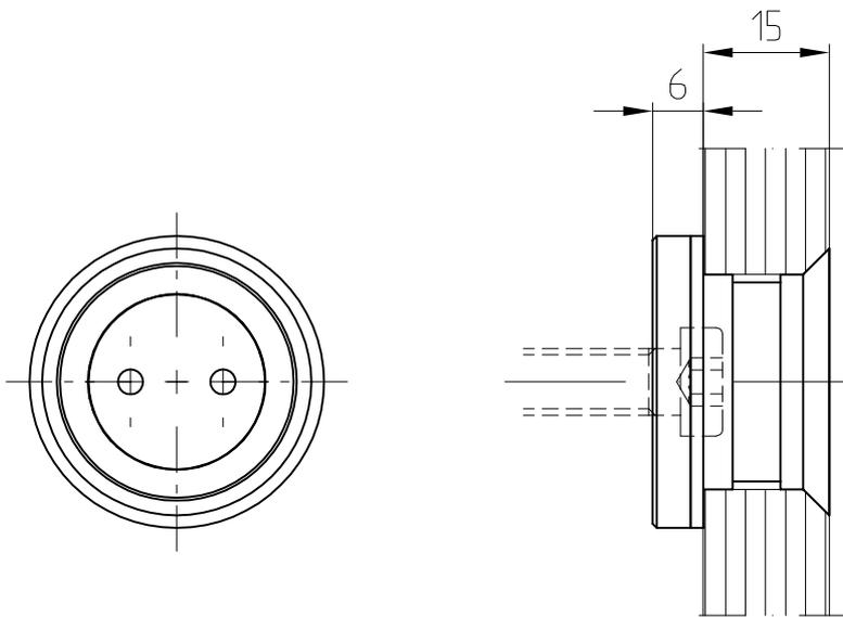
Befestigung mit Zylinderkopfschraube
