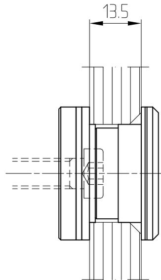
Befestigung mit Zylinderkopfschraube
