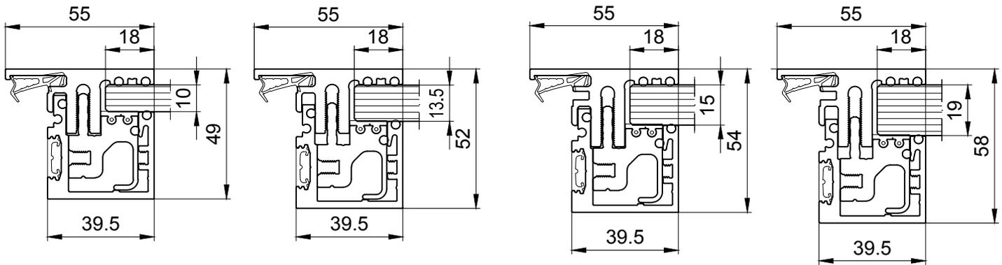
Zarge 55 mm, Adapter zur Anbindung an das Aufnahmeprofil
