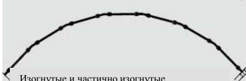
Изогнутые и частично изогнутые конфигурации направляющих рельсов (мин. радиус 3 метра)
