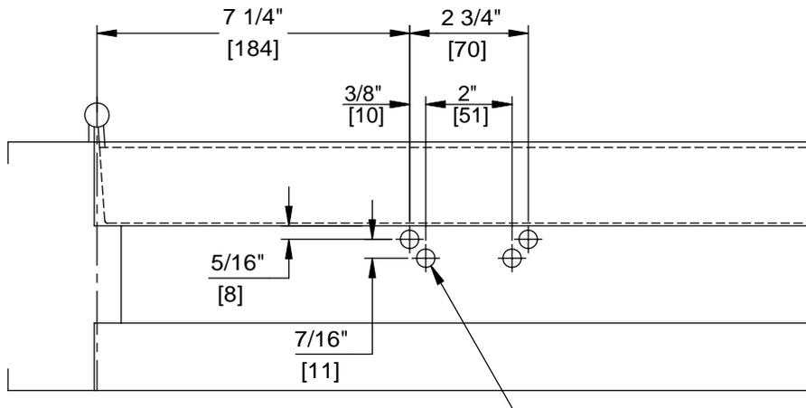
FOR 1/4-20 MACHINE SCREWS USE 7/32" DRILL
