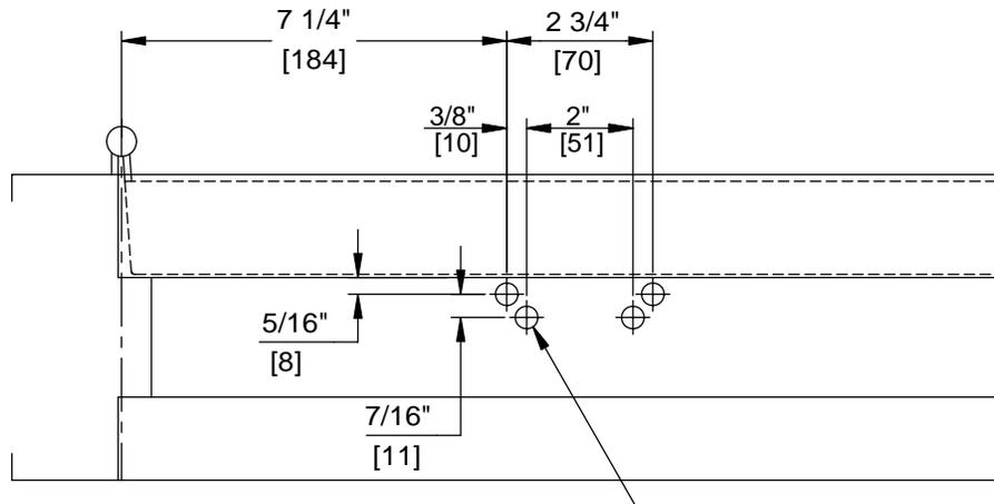
FOR 1/4-20 MACHINE SCREWS USE 7/32" DRILL
