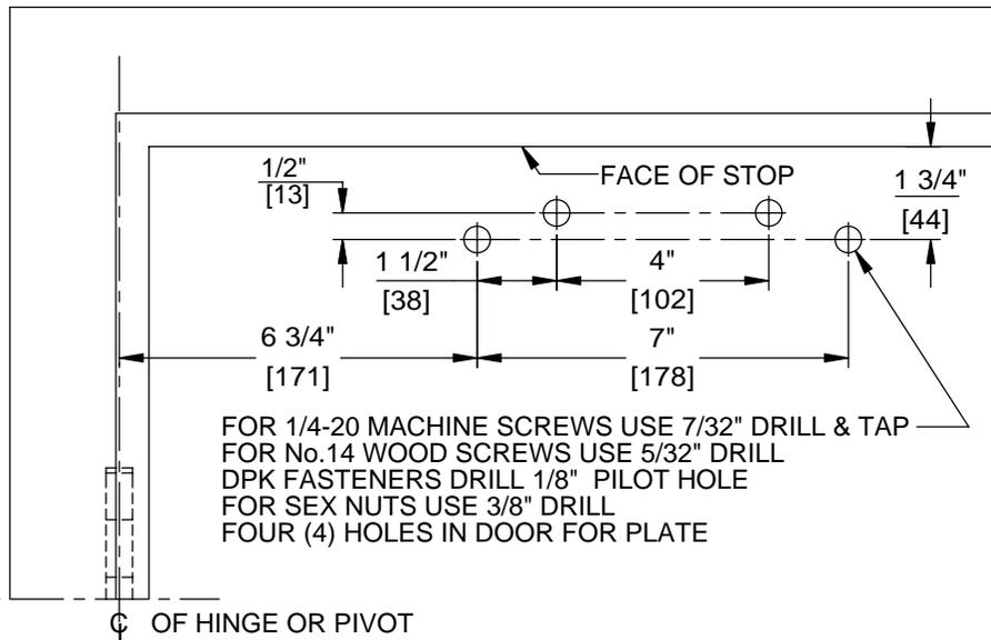
FOR 1/4-20 MACHINE SCREWS USE 7/32" DRILL & TAP
