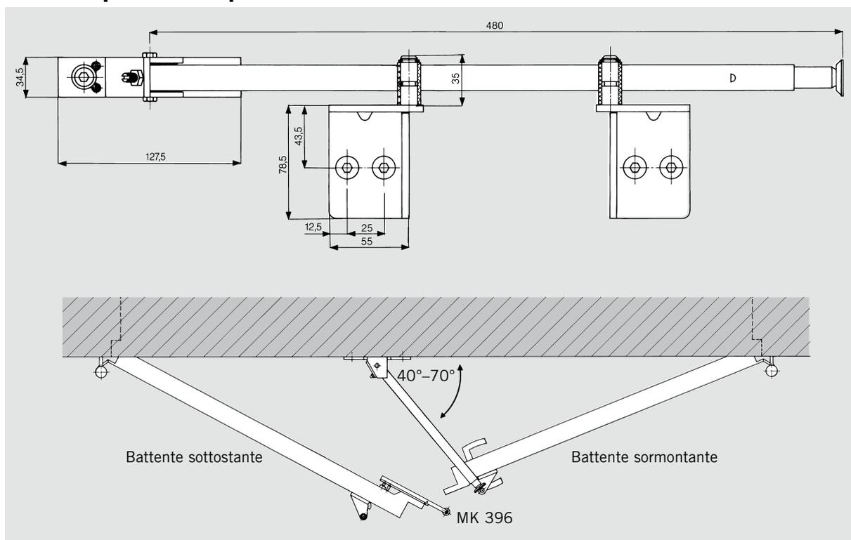
**Il DORMA SR 390 è un regolatore di chiusura affermato ad azionamento completamente meccanico, da usare per porte a due battenti, antincendio ed a tenuta di fumo.**
