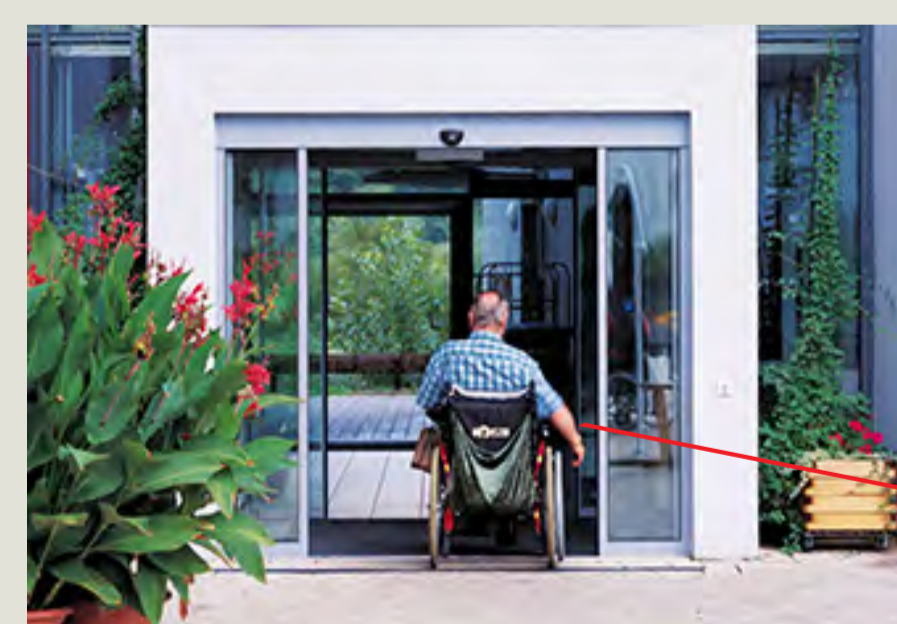
Puerta corredera automática asociada a un transpondedor o emisor/receptor
