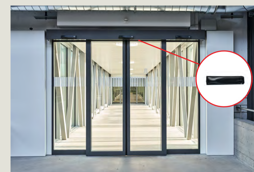
Puerta corredera automática combinada con un detector de movimiento y un dispositivo de seguridad optimizado. El dispositivo se lleva en el bolsillo o, por ejemplo, en una silla de ruedas, y permite el acceso por señal de radio, pasando cerca del detector combinado con una puerta automática. El contacto por radio provoca la apertura automática para las personas en posesión del transpondedor o de un emisor/receptor
